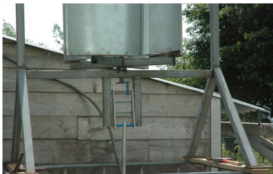
Pompe éolienne Zoom sur le mécanisme de la pompe éolienne
