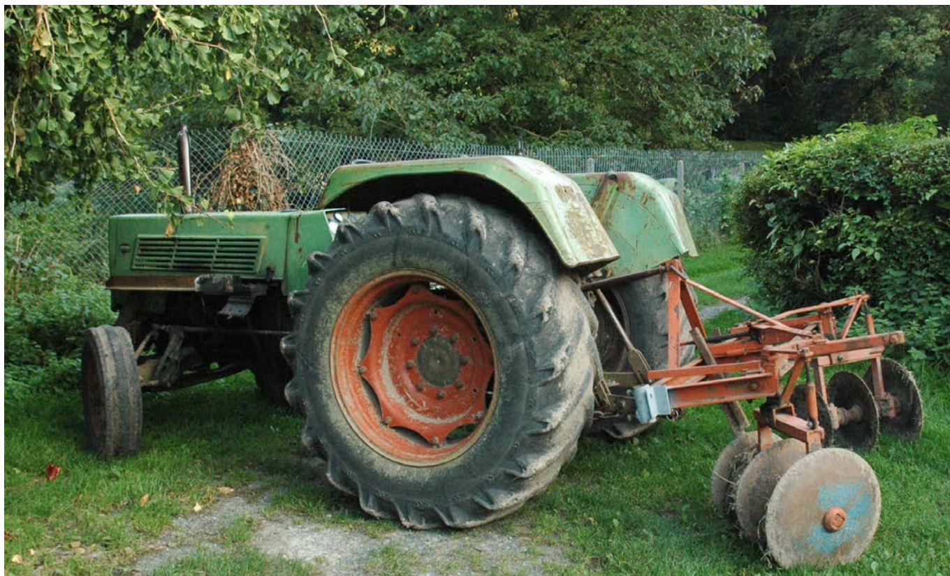
Tracteur avec butteuse pour la gestion des planches et des allées de plein champ
