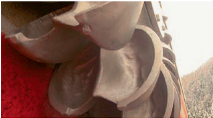
Fig. 3 Photo de l'abrasion de la turbine Pelton à la station d'épuration de Profay après 14 années d'exploitation [4], (cf. encadré 2)
