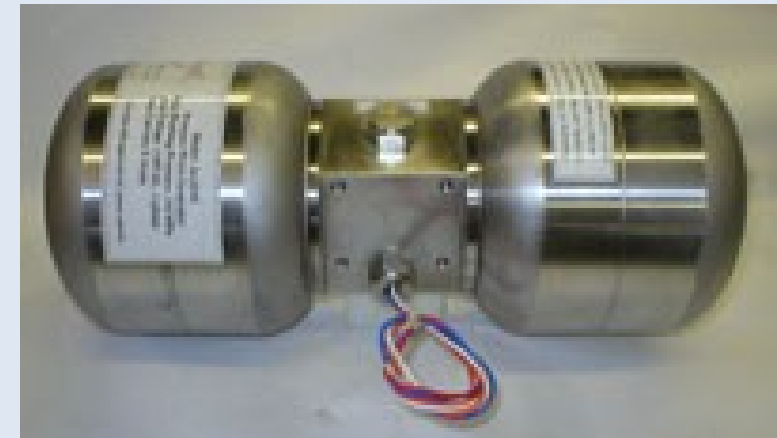
2 moteur/alternateur couplés avec leur enceinte.
