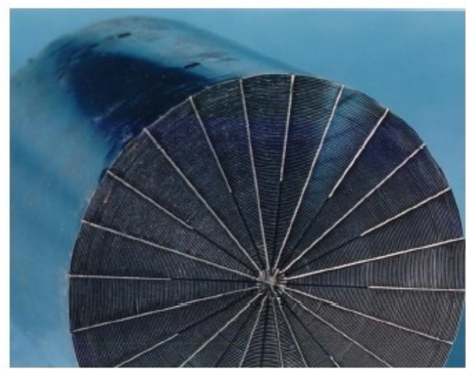
Stack constitué d'un enroulement de ruban d'acier inoxydable distance interplaques de l'ordre de 300 \mu\text{m}
