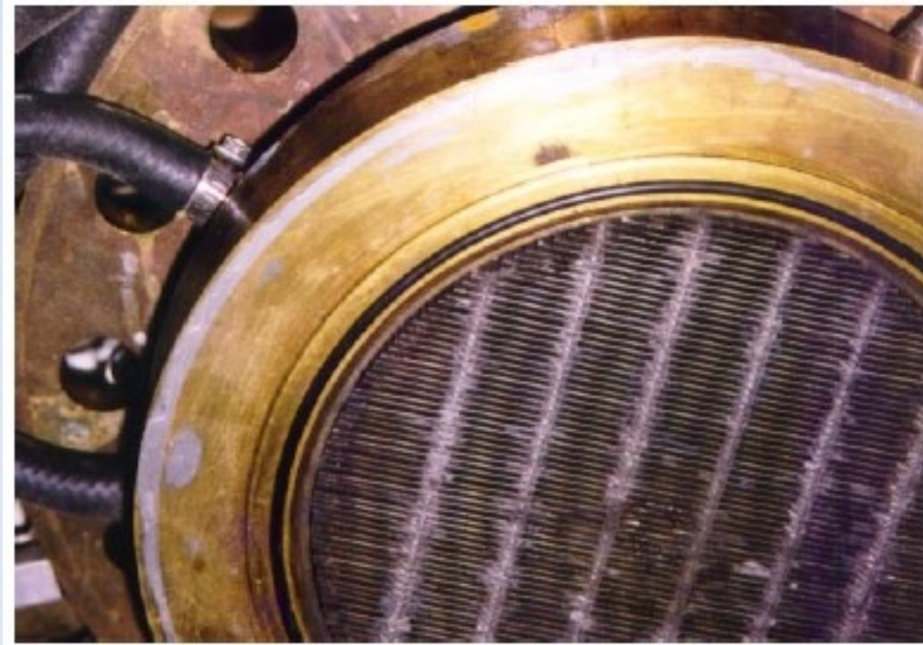
Exemple: échangeur de chaleur froid
