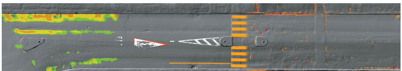
Figure 9. Détection des déformations (ornières), de la signalisation horizontale et des dégradations sur la rue de l'Helvétie à La Chaux-de-Fonds.
