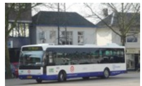
L'autobus Whisper à moteurs roues de la compagnie eTraction
