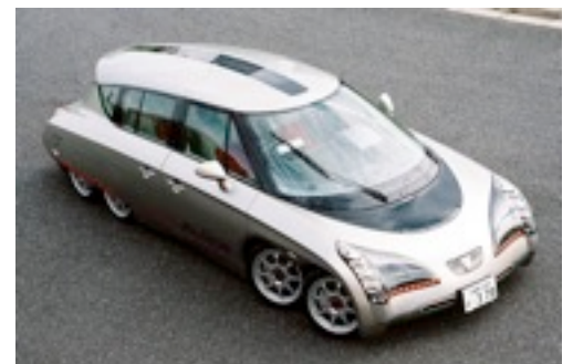
La Eliica à 8 moteurs-roues de Hiroshi Shimizu présentée en 2004.
