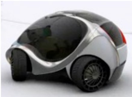
La Hiriko tourne sur elle-même grâce à ses roues indépendantes.
