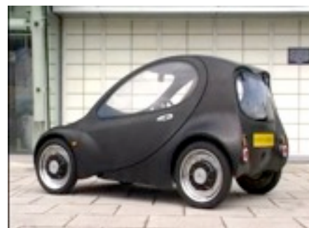
La Riversimple à 4 moteurs-roues
