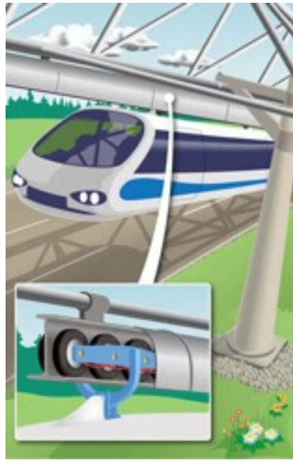
Monorail suspendu à moteurs-roues conçu par Pierre Couture
