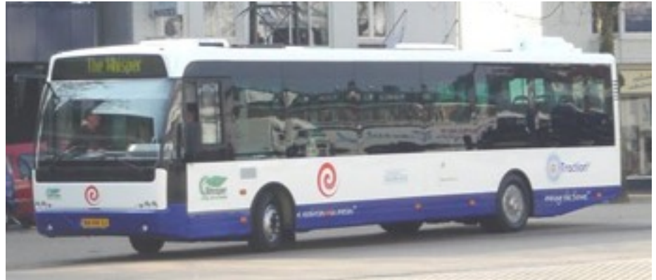
Le Whisper, un autobus hybride série de e-Traction, est équipé de deux moteurs-roues électriques à l'arrière (photo: e-Traction)
