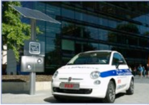
La Fiat convertie par FEV en voiture électrique avec prolongateur d'autonomie, ci-dessus, et son dessous, à droite (photos: FEV)
