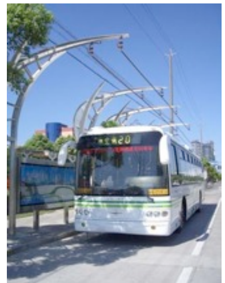
Autobus biberonné à supercondensateurs de Sinautec, au poste de recharge.(photo: Sinautec)
