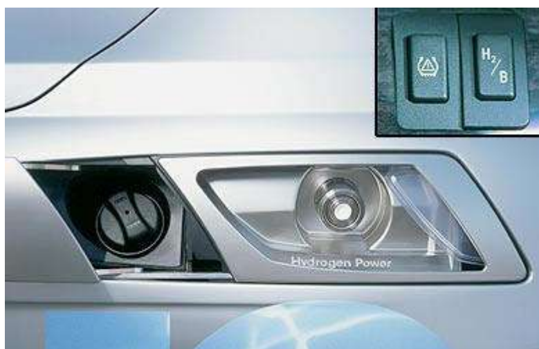
Gros plan sur les goulots des deux réservoirs de la 745h et sur le bouton qui permet de basculer de l'un à l'autre.
