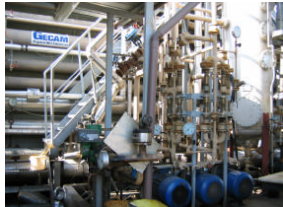
Process de fabrication de l'émulsion : pompe pour mélanger eau et gazole (Gecam)
