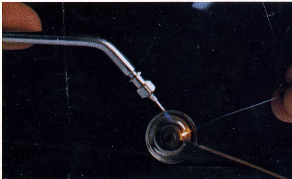
Opération de brasage sur une pièce de dimension faible
