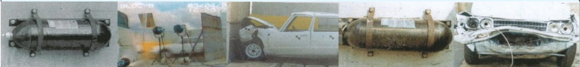
Impact à 65 km/h d'un véhicule sur réservoir au Terrain Expérimental Extérieur du CESTA
