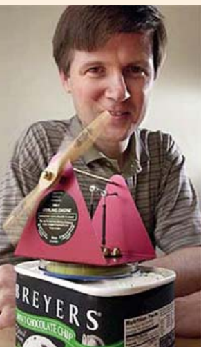
La différence de température entre l'air ambiant et le pot de crème glacée permet à un moteur Stirling de faire tourner une hélice.
