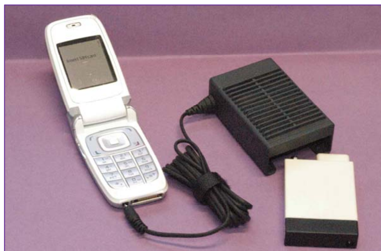
Téléphone chargé par une micropile © Artechnique / CEA
