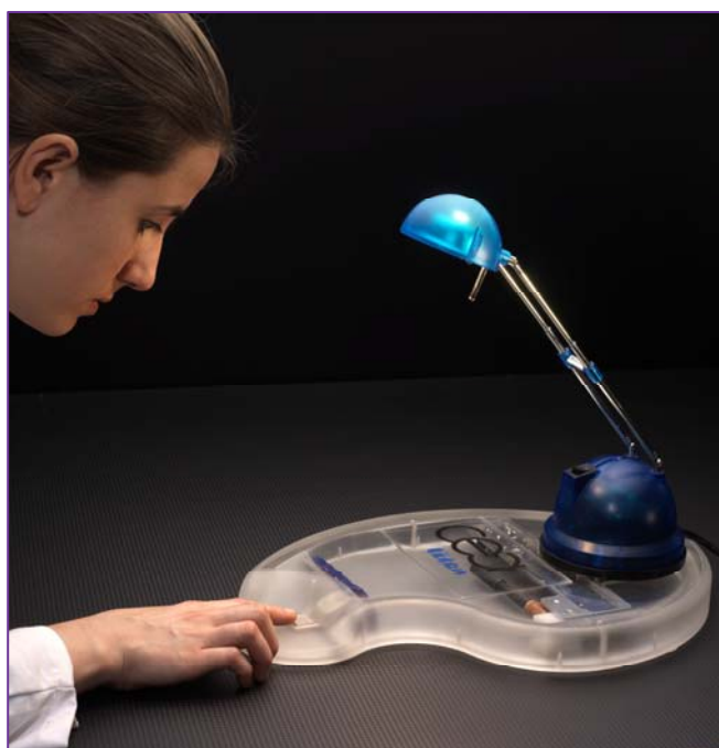
Lampe dotée d'un interrupteur : la chaleur du doigt suffit à générer une impulsion déclenchant un interrupteur © Artechnique / CEA
