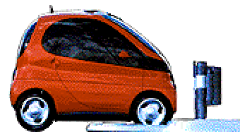
La tulip : le micro-car français électrique du réseau Liselec (caractéristiques complètes en annexe 10 a)
