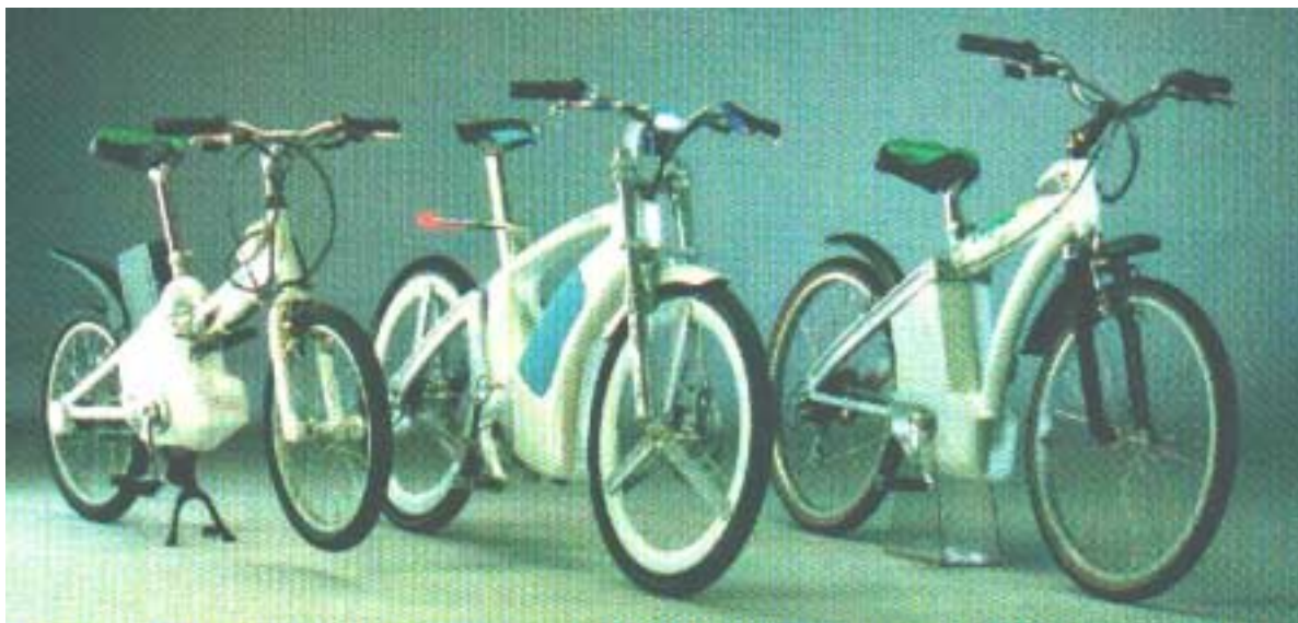
Vélo à assistance électrique de la gamme Th!nk. : aide au démarrage et récupération de l'énergie de freinage via un alternateur/moteur électrique
