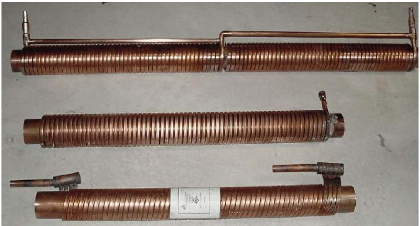
Figure 2 Trois récupérateurs de chaleur mis à l'essai dans la phase I de l'étude. De haut en bas : ReTherm S3-60, GFX G3-40 et PowerPipe R3-36.
