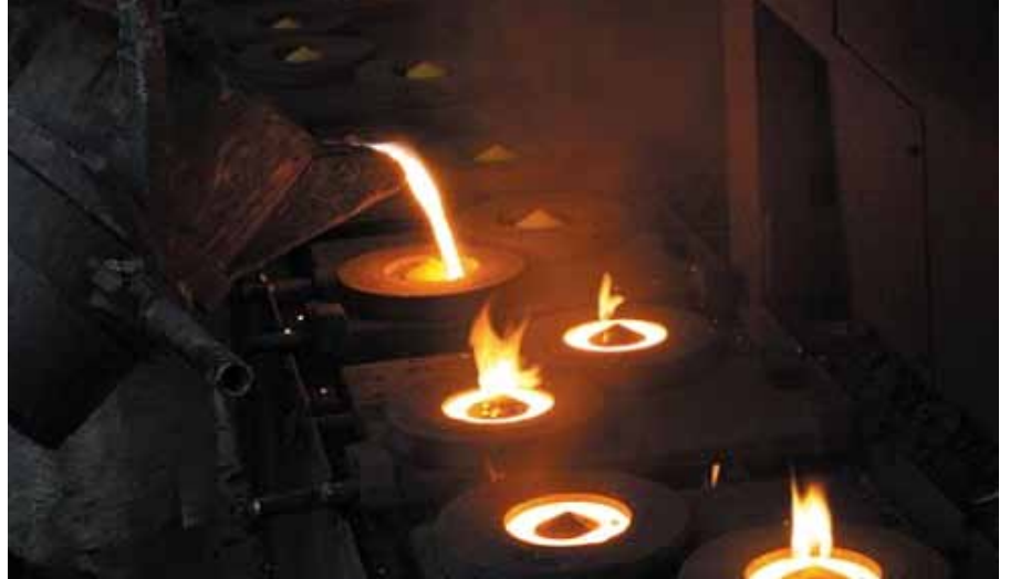
Processus de coulée des segments de piston
