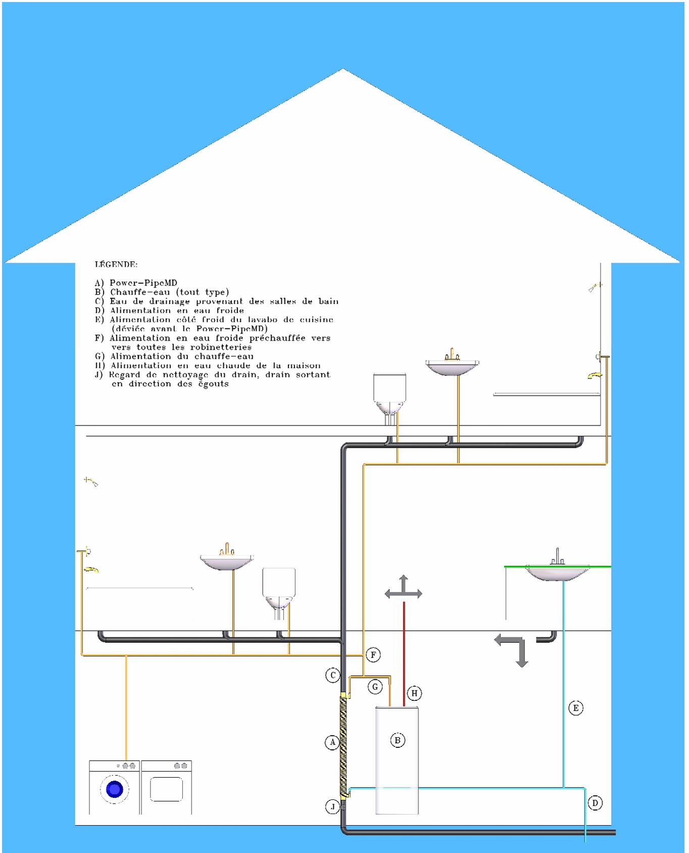
Figure 2: Configuration privilégiée pour l'installation d'un récupérateur de la chaleur des eaux de drainage Power-Pipe<sup>MD</sup>
