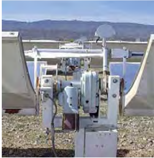
Ilustración 1.12. Sistema de seguimiento en un eje de un canal parabólico accionado por un motor eléctrico.
