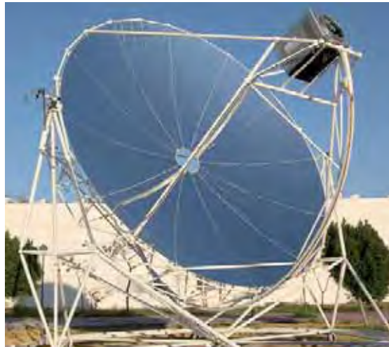
Ilustración 3.5. Disco parabólico con motor Stirling del GTER en la Escuela Superior de Ingenieros de Sevilla.
