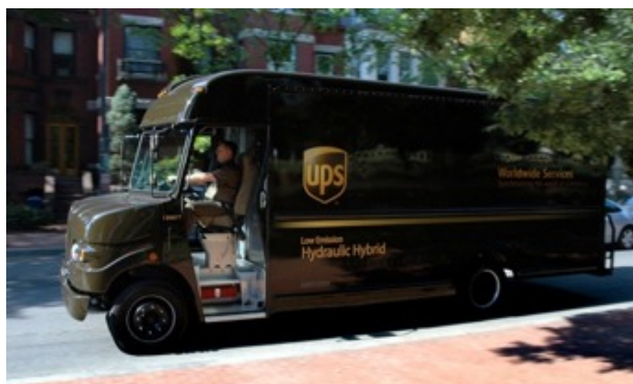
Un camion de livraison UPS transformé en hybride hydraulique, en 2006, par l'EPA et ses partenaires, dont UPS et Eaton corporation.
