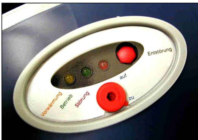
Fig. 13 : Témoins RE 1H / RE 1HK DEL jaune → préchauffage du fuel DEL verte → fonctionnement DEL rouge → dysfonctionnement Touche de réarmement
