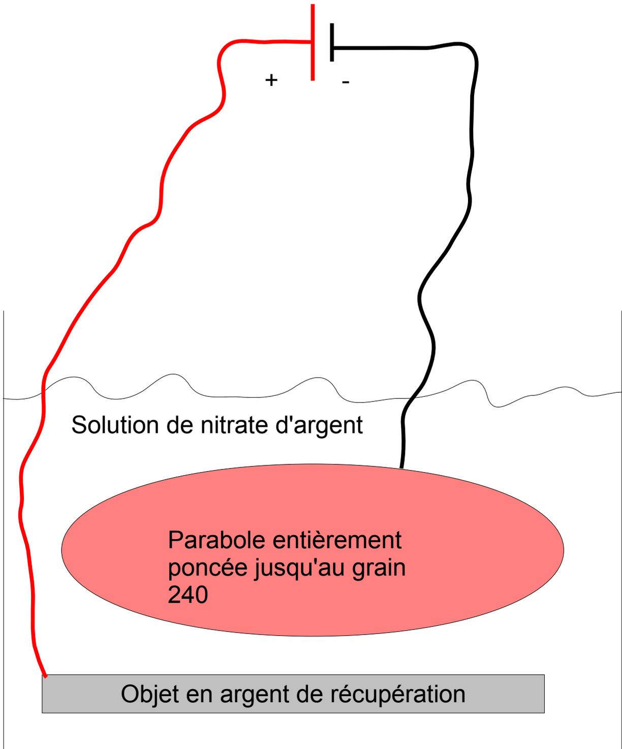
Électrolyse à faire dans l'obscurité à l'aide d'une batterie de voiture pendant plusieurs jours.
