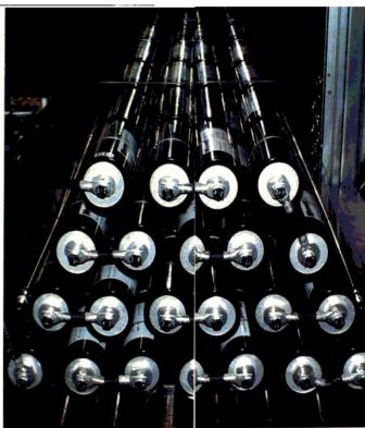
rempli d'un liquide ionisé. Quand l'ultracondensateur est chargé, les ions de l'électrolyte s'accrochent à la surface de carbone de chaque plaque et sont séparés par un espace de la dimension d'un ion : guère plus d'un nanomètre! D'où le ratio d'un trillion et
