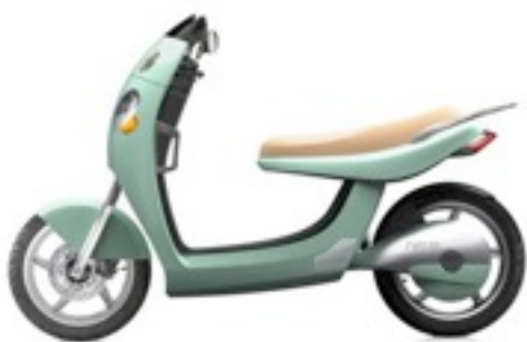
Le scooter électrique E-165 à moteur-roue de KLD (105 km/h)
