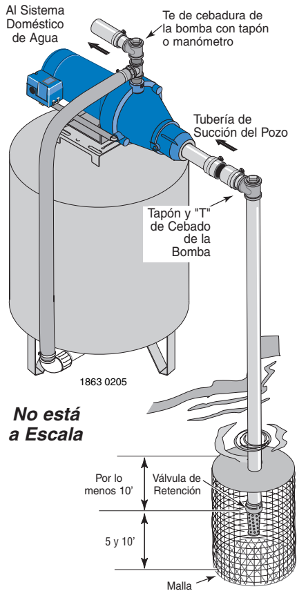
Figura 3: Instalación para agua superficial
