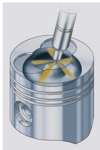
Spray Diesel, hétérogénéité du milieu. Source PSA - CDRM - Le Moteur HDI
