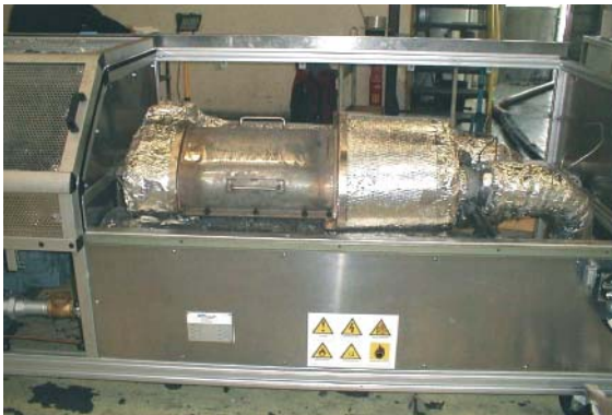
Installation Comela vue de face avec le filtre à régénérer. Source RATP
