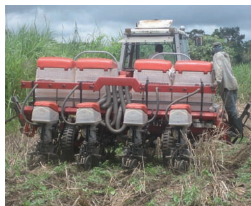
En haut : Formation à l'utilisation d'un semoir à coup de pointe pour le semis direct, au Burkina Faso. (John Ashburner) En milieu : Semis direct avec un équipement spécial à traction animale, en Zambie. (Josef Kienzle) En bas : Un semoir en action, sans labour préalable, sur une grande exploitation, au Cameroun. (Josef Kienzle)
