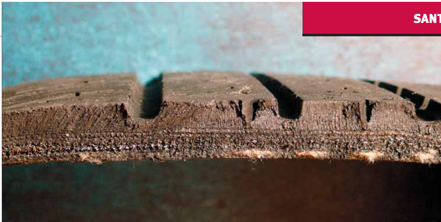
▲ Les pneus à ceinture d'acier sont aujourd'hui l'équipement courant des voitures particulières. Ils sont composés d'une bande de roulement profilée, d'une carcasse d'acier, d'une assise textile, ainsi que d'un enduit intérieur de gomme.
