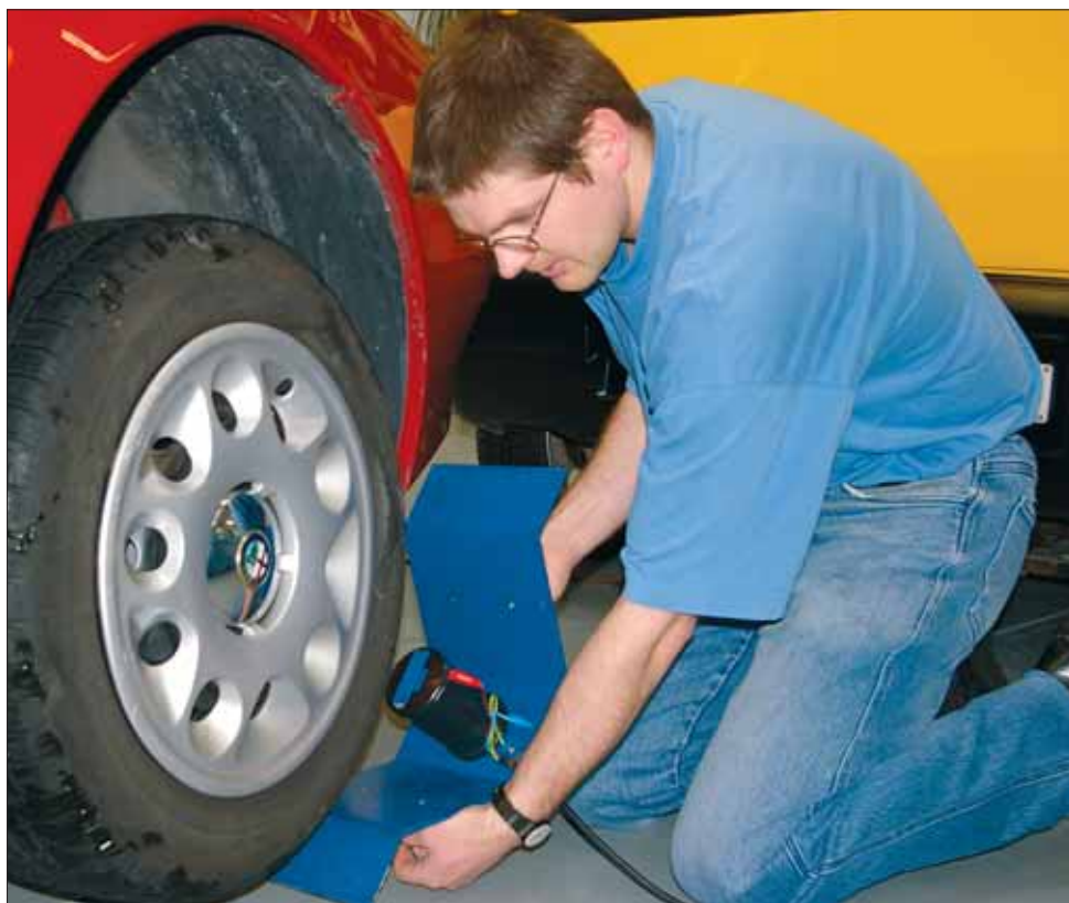
▲ Des pneus démagnétisés peuvent à nouveau se magnétiser avec le temps. Par conséquent, un contrôle périodique s'impose.
