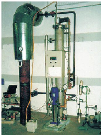
Figure 2 : Réduction d'azote par un dégazage de courant partiel 'servitec' dans une installation pilote
